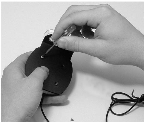
**Fixez l'antenne du iFINDER au support pour pare-brise avec deux vis.**
