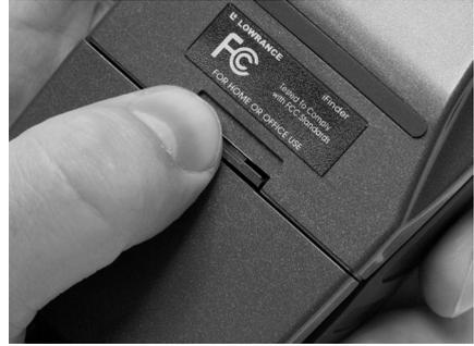
Repositionnez le couvercle du compartiment à piles. Alignez les pattes du couvercle avec les fentes présentes à la base du boîtier, à gauche. Appuyez fermement sur l'onglet jusqu'à entendre un clic, comme illustré à droite.
